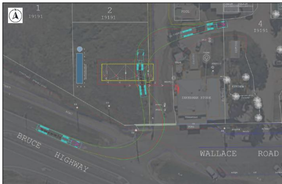
Figure 3.7: 19m AV Swept Path (Accessing High Flow Fuel Bowser)
