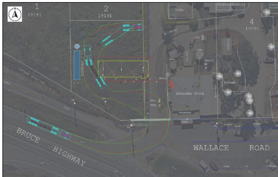
Figure 3.6: 19m AV Swept Path (for Bulk Fueling)
